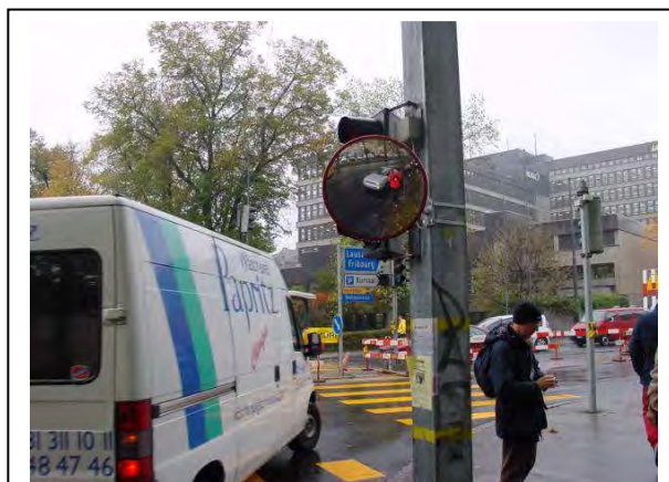
Lo specchio permette ai conducenti di vedere i ciclisti che li affiancano sul lato destro della carreggiata (Berna – Foto Polinomia)
